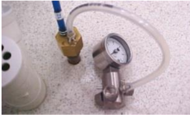
Imagen 11. Conexión de manómetro de chequeo presión estática de entrada de aire
