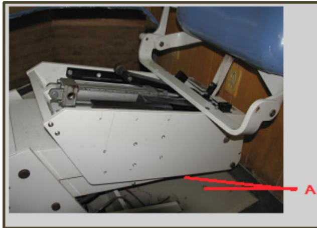
Imagen 2. Pernos de sujeción de la base de la silla A-DEC. Fuente autores
