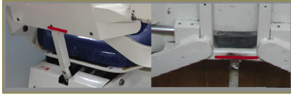
Imagen 12. Fisuras por esfuerzos cortantes. Fuente Autores.
