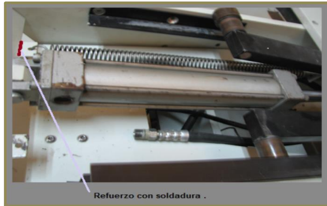
Imagen 7. Programación refuerzo con soldadura.
