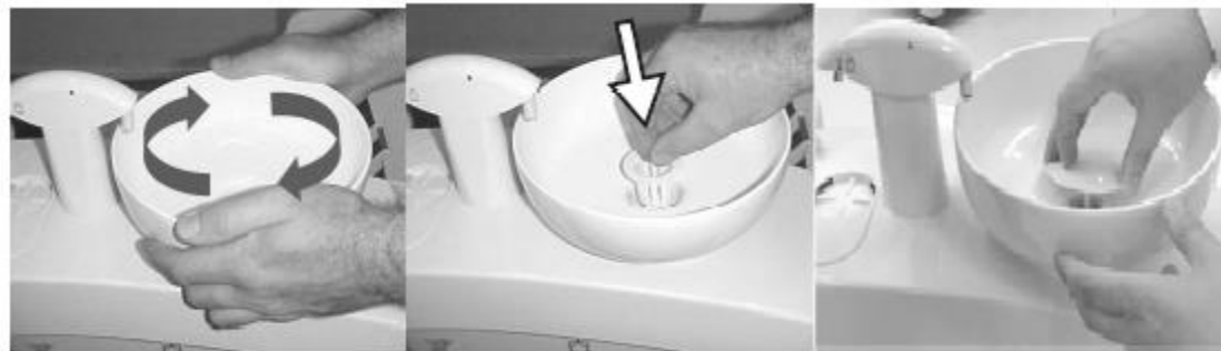
Imagen 40. Desmontaje de la escupidera
