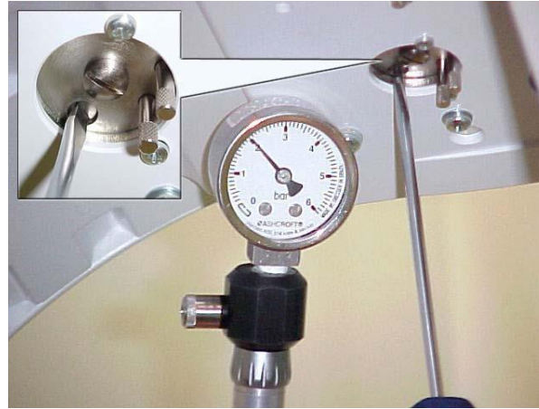
Imagen 16. Tornillo de regulación de presión de aire para los instrumentos
