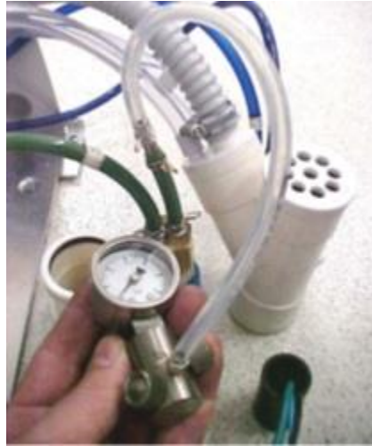
Imagen 12. Conexión de manómetro para medición de presión estática entrada de agua
