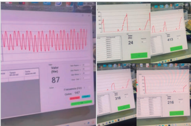
Ilustración 6. Prueba cíclica de fatiga.
