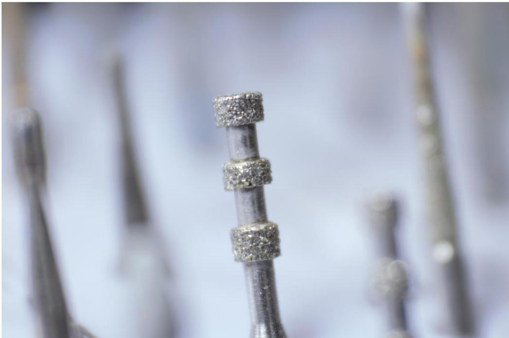
Piedra de diamante calibrada para preparaciones. Se visualiza zonas de desgaste (activa) y zonas del vástago sin diamante (inactivo).
