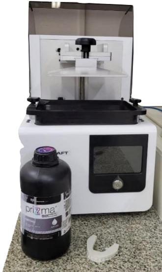
Impresora 3D que se puede utilizar con diversas resinas para la confección de modelos de estudio impresos y resina líquida.
